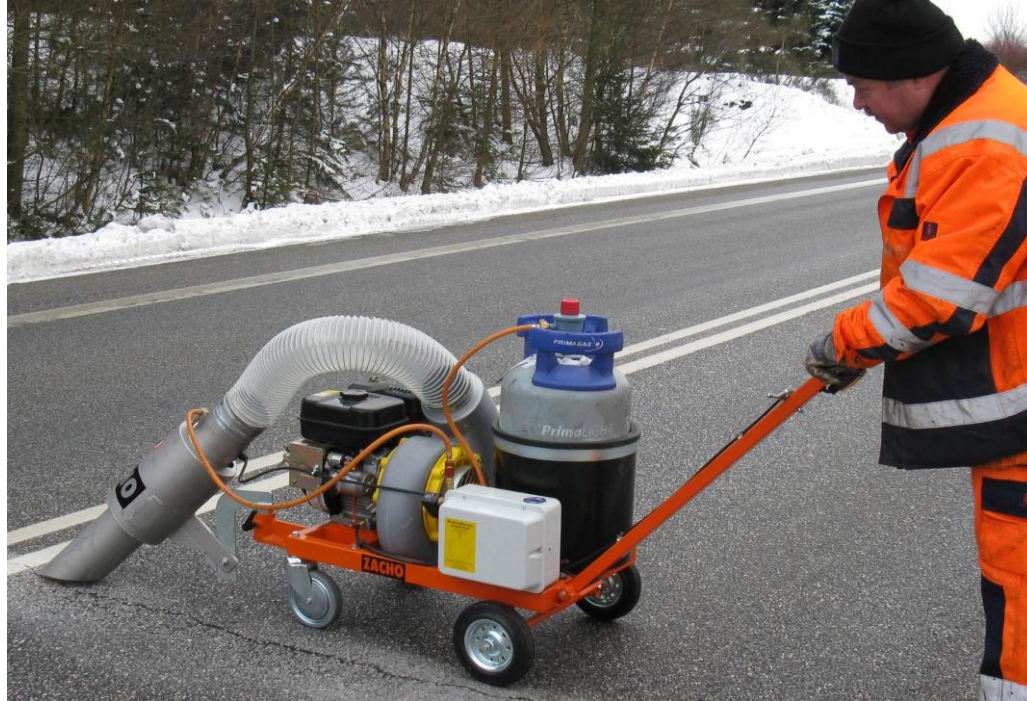
Gassoppvarmet fugevogn FV20 med 2 varmesoner
